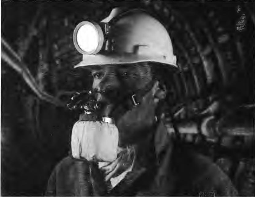
Der neue Filterselbstretter FSR W 95 kombiniert die Nutzung der hervorragenden Eigenschaften von Hopkalit- und Edelmetallkatalysatoren und erreicht dadurch höhere Leistung, verbesserten Atemkomfort und doppelte Haltezeit. Der seit Jahrzehnten bekannte und bewährte Aufbau des AUER Filterselbstretters mit seiner bequemen Trageweise mit Kopfband konnte beibehalten werden.
