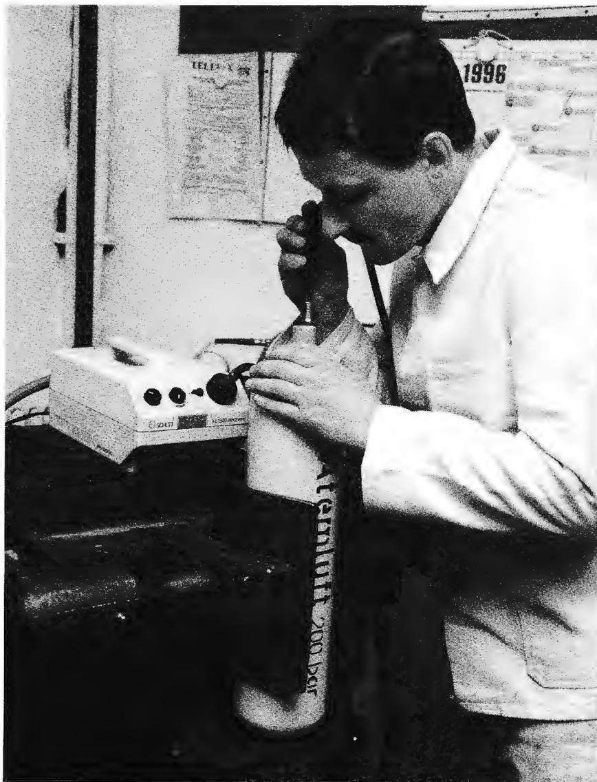
*Innenbesichtigung eines Druckgasbehälters*
