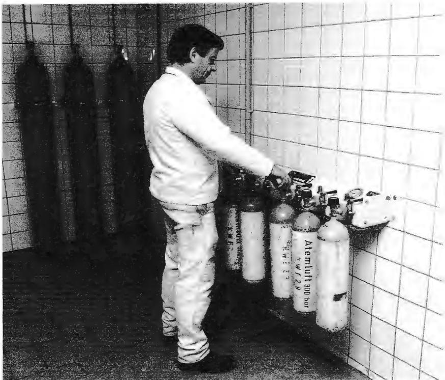
*Füllen von Druckgasflaschen*
