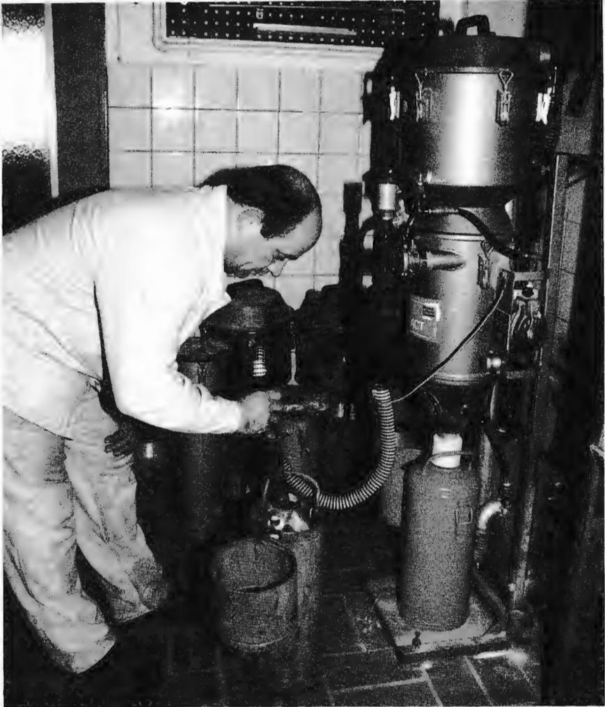
*Absaugen und Wiederbefüllen eines Feuerlöschers*
