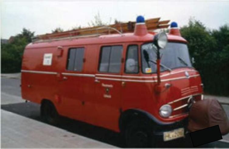
*LF 8 Mercedes-Benz mit Vorbaupumpe 8/8, vergleichbares Fahrzeug*
