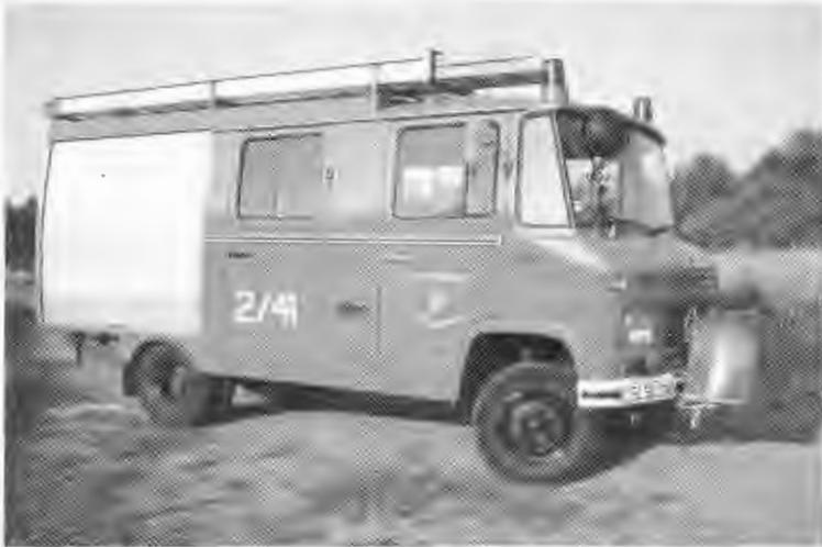
***Löschgruppenfahrzeug LF8.** Baujahr 1978. Besatzung Gruppe 1/8. Fahrgestell Mercedes Benz, Aufbau Fa. Metz. Pumpenleistung der im Heck eingeschobenen TS8/8, wie auch der Vorbaupumpe ist 800 l pro Minute bei einem Druck von 8 bar. Rufname Florian Nalbach 2/41.*
